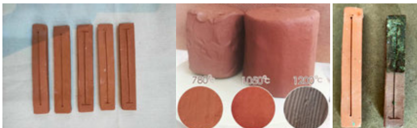
ภาพที่ 6 แสดงสีดินและการหดตัวของดินเหนียวหลังการเผา
