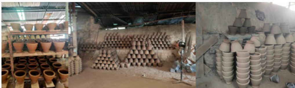
ภาพที่ 3 แสดงวิธีการผึ่งงานหรือตากงานให้แห้ง ก่อนจะทำการเผาชิ้นงาน
