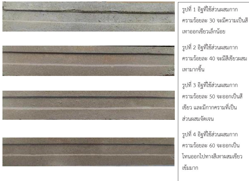
ภาพที่ 11 ความแตกต่างของอิฐบล็อกที่มีกากครามเป็นส่วนผสมในแต่ละสูตร
