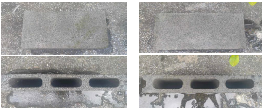
ภาพที่ 13 คอนกรีตบล็อกทั่วไป (ซ้าย) และ คอนกรีตบล็อกที่มีส่วนผสมกากคราม (ขวา) หลังการทดสอบแช่น้ำ
